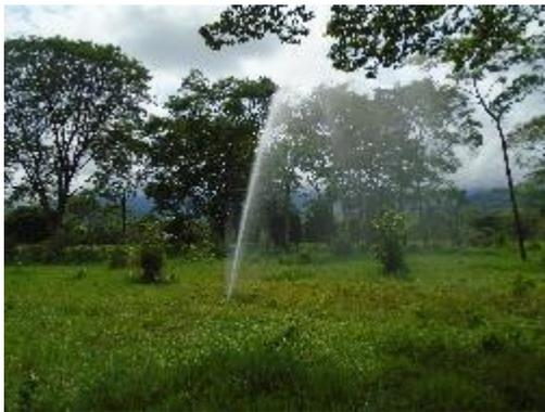
**Fotografía 22.** Conducción (fuga por ruptura en la tubería)
